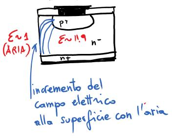
st BEVELING si aumenta la lunghezza delle lince di fotza per ridurre il compo elettrico. all'interfecció con l'aria
