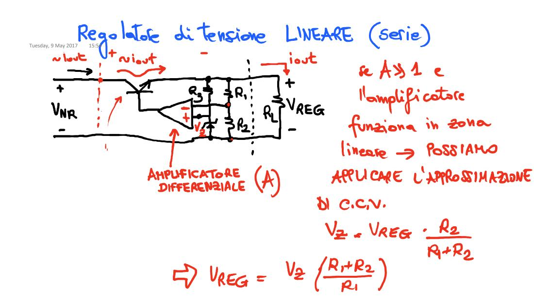
LA POTENZA DISSIPATA NEL TRANSISTORE DI PASSO
