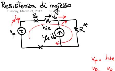
) Applico il generatore ideale di prova ) RIMMOVO RB > Rasolvo Vp= hie 16+ (hfe+1) 16 R\* <u>vp</u> <u>vp</u> <u>hie</u> + <del>R</del> (hfe+1) > Re-inserisco RB RAN = RB // hie + R\* (hfe +1)]
